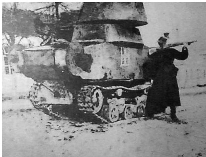
Саморобний танк загону УПА в ім. Богуна зроблений на базі тягача СТЗ-5 та корпусу Т-26. Захоплений поляками. Купичів, грудень 1943 р.
